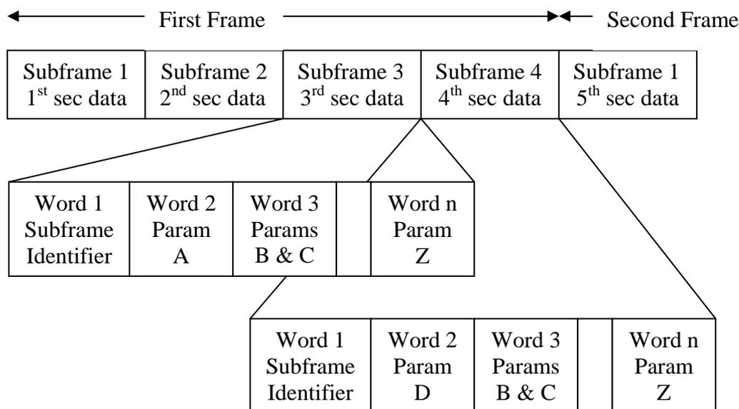
**Figure 1 Frame-Subframe Structure**
