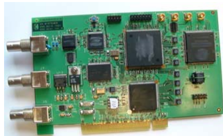
Figure 5 : La station MTV 2000 et sa carte de traitement spécifique
