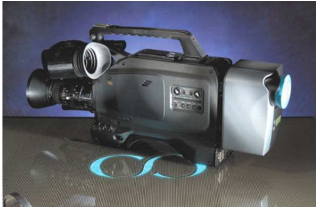
2004 - Caméscope de Sinclair Broadcast Group alimenté par une pile à combustible de Jadoo Power System
