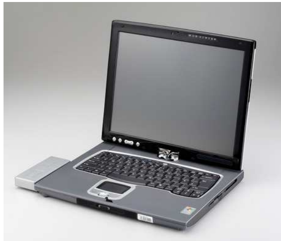
2006 - Ordinateur AVC Corp. équipé d'une pile DMFC Antig Tech. (Taiwan) de 45W pour 8h d'autonomie.
