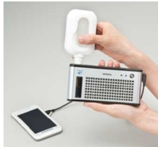
TOSHIBA Dynario DMFC (Méthanol) Chargeur à pile DMFC pour nomade. Pré-commercialisé en novembre 2009 (3000 ex. distribués) au prix de 220 euros. Courant de charge 400 mA.
